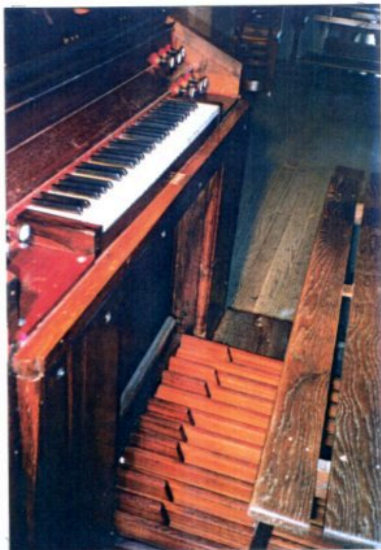
Console ouverte: les départs de mécanique
