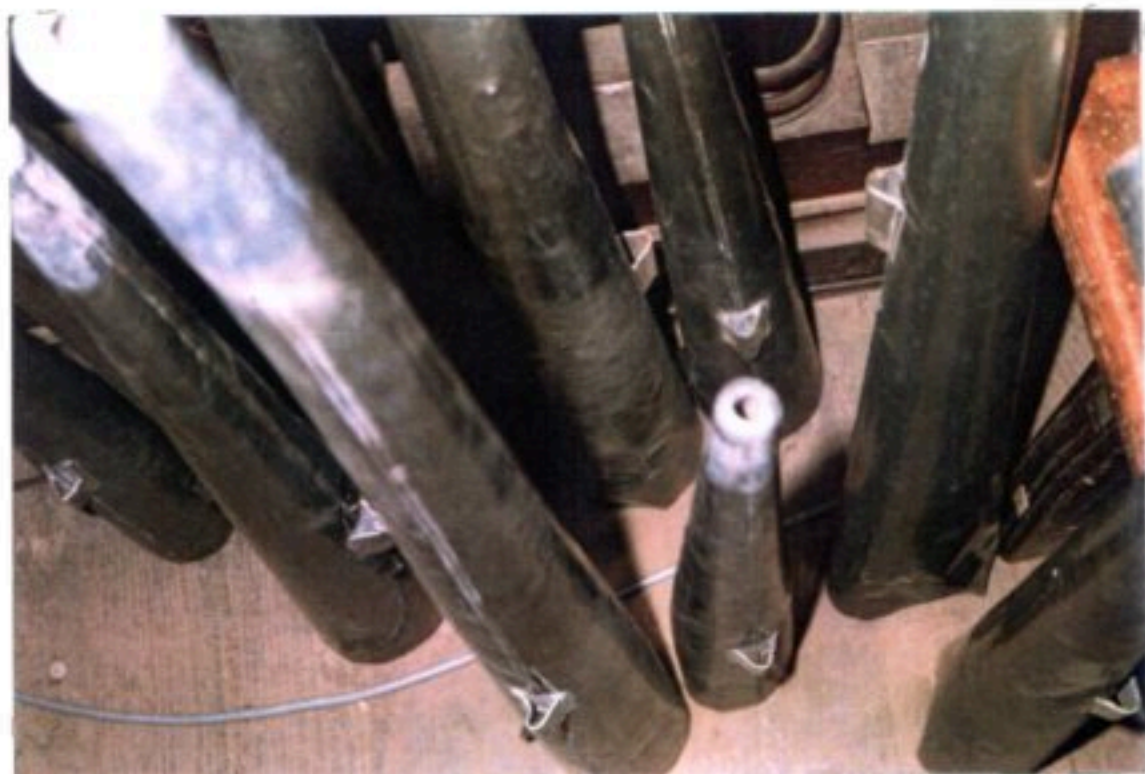
Basses de Clairon : pointes de pavillons fraisées
