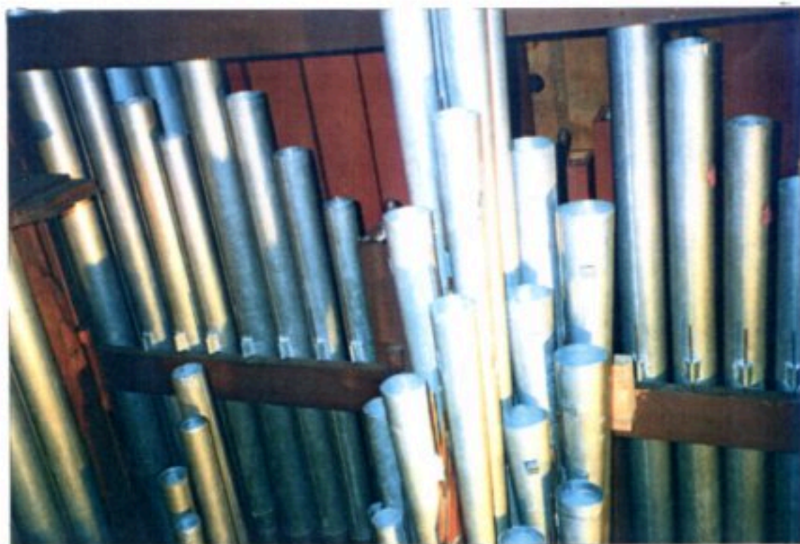
Les basses postées,côté UT*:Flûte Harmonique : C1-B1 bois,C2-F2; Prestant (Dulciana) : C1-G1; Bourdon : C1-F2 bois; Flûte Octaviante : C1-G1
