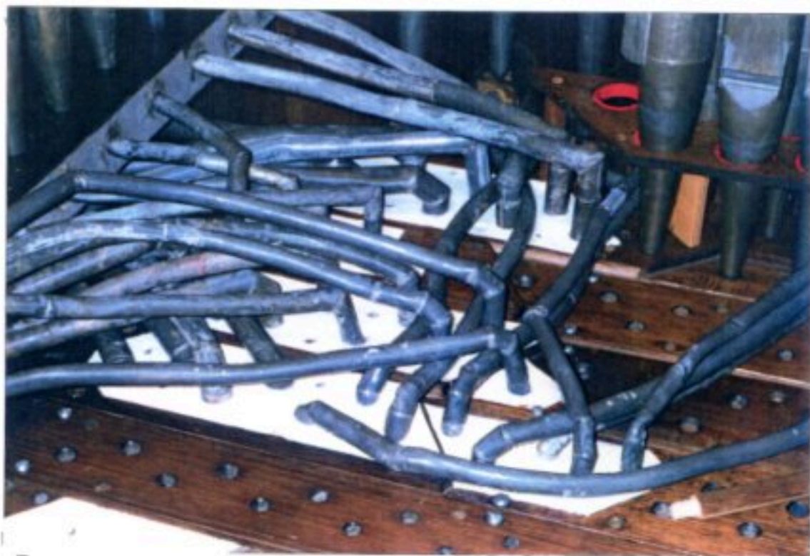
Gros plan sur les postages,côté UT
