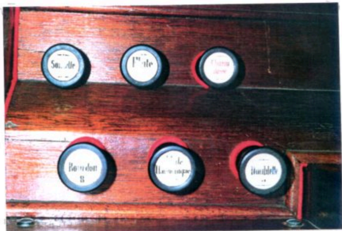
Boutons de registres à gauche du clavier
