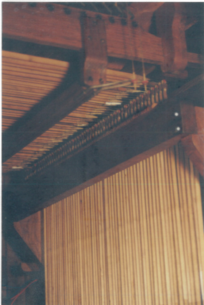
photo 21 : commandes de notes barres d'équerres abrégés vergettes
