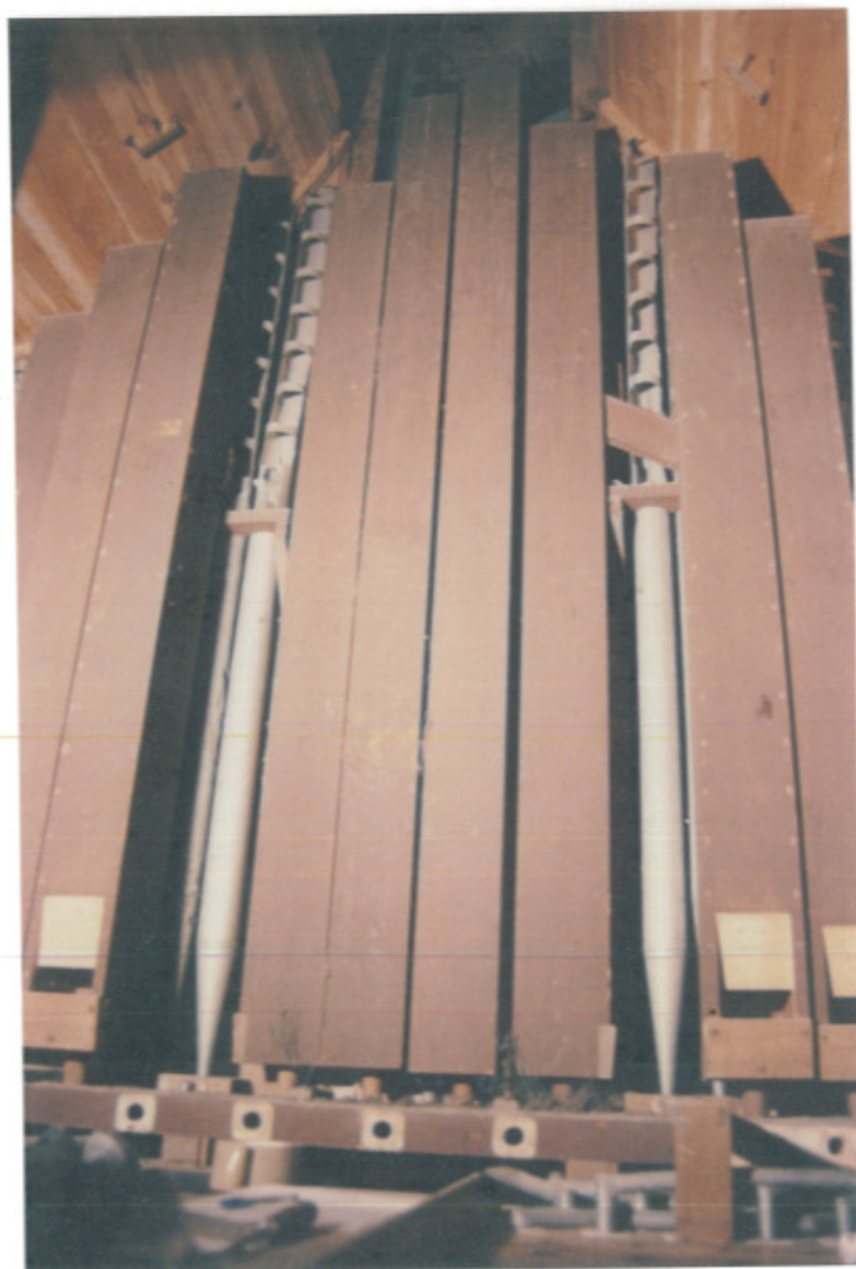
photo 12 - Tuyaux bois Montre 8
