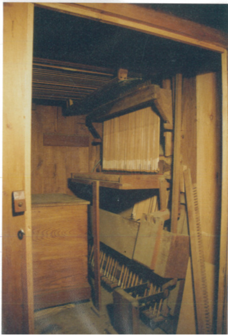
photo 4 - mécanique de commandes de notes et de tirasses
